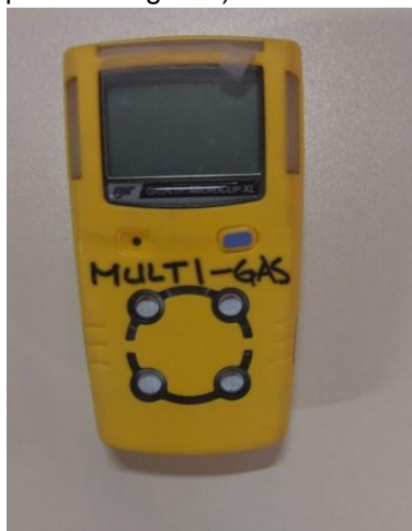
e. Medidor multi-gases (Cianuro de Hidrógeno, monóxido de carbono, oxígeno, límite inferior de exposición a gases).
