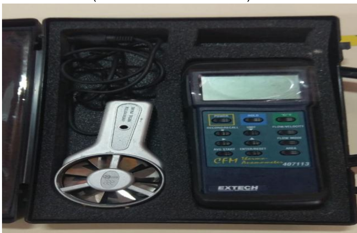
c. anemómetro (mide velocidad del viento).
