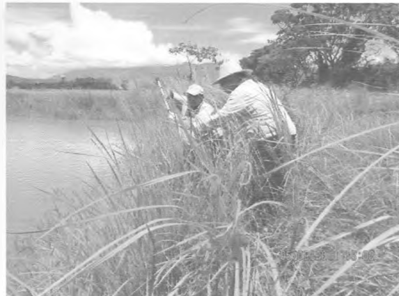
LLENADO DE LA BOLSA ESTÉRIL CON LA MUESTRA DE AGUA DE LA LAGUNA
