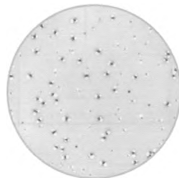
VISUALIZACIÓN EN EL CONTADOR DE COLONIAS DEL CRECIMIENTO MICROBIANO POR COLIFORMES EN PLACAS DE PETRIFILM MR
